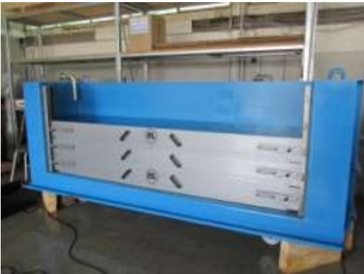
Bild 6.3-9: Verringerung des Wasserstandes und Rückbau der Dammbalken
