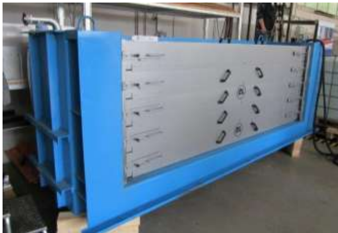
Prüfbox nach dem Einbau des Hochwasserschutzsystems
