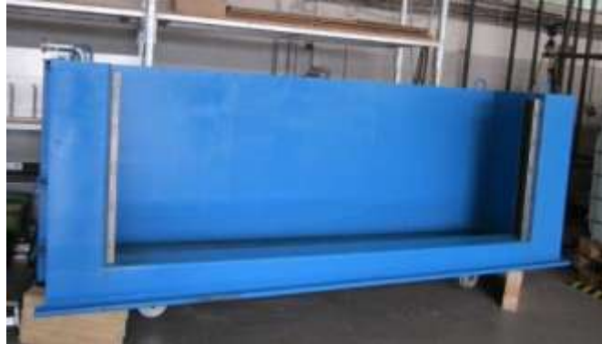
Prüfbox vor dem Einbau des Hochwasserschutzsystems
