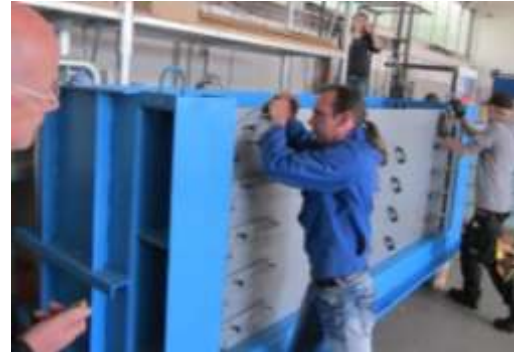
Bild 6.2-2: Befestigung der Dammbalken
