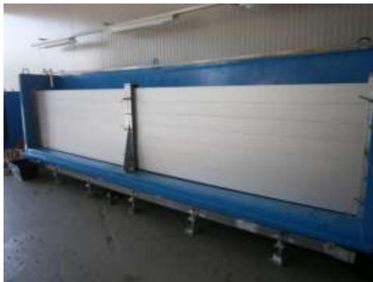
Prüfbox nach dem Einbau des Hochwasserschutzsystems
