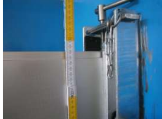
Bild 5-2: U-Aufnahme und Dammbalken mit Vertikalspanner
