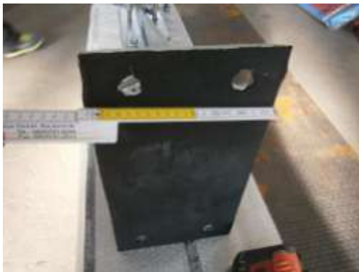
Bild 6.2-3: gelagerte Mittelstütze, Sohlenanschluss
