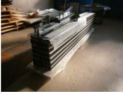
Bild 6.2-1: Dammbalkenelemente, gelagerte Profile
