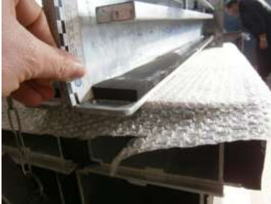
Bild 5-1: Mittelstütze der Messeinrichtung mit Führungsschiene
