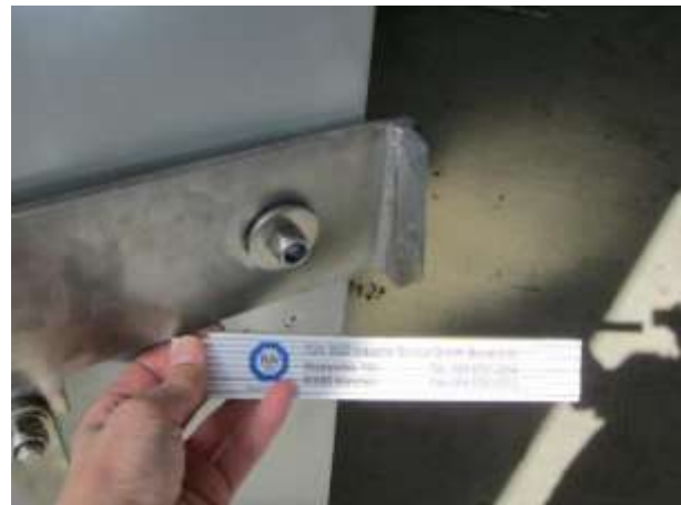
Bild 5-4: Riegelmechanismus und Befestigungsschrauben der Schutztür
