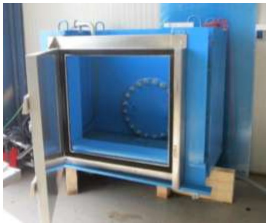
Prüfbox nach dem Einbau des Hochwasserschutzsystems im geöffneten Zustand
