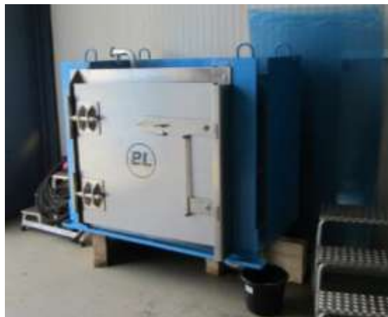
Prüfbox nach dem Einbau des Hochwasserschutzsystems im geschlossenen Zustand
