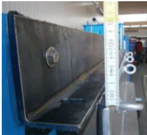
Bild 5-3: Oberer Abschluss der Messeinrichtung
