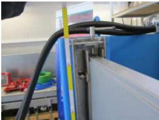
Bild 6.2-5: Fixierung der Dammbalken mittels Vertikalspanner
