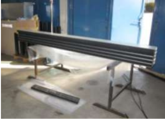
Bild 6.2-1: Dammbalkenelemente, gelagerte Profile
