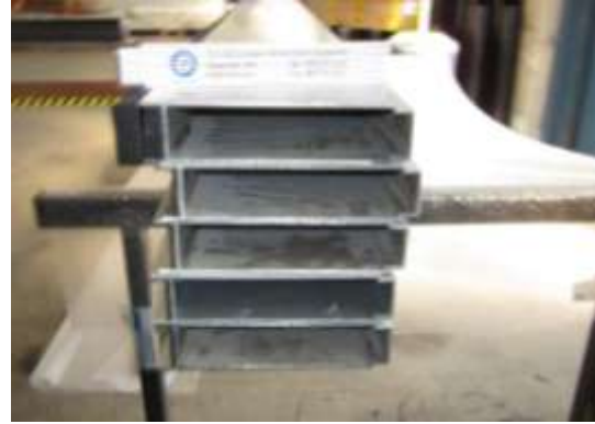
Bild 6.2-2: Dammbalkenelemente, gelagerte Profile
